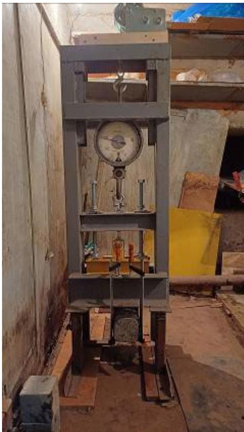
Рис. 2. Общий вид экспериментальной установки для создания предварительного обжатия бетона
