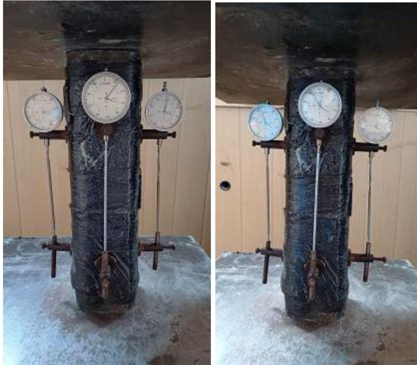
Рис. 5. Образец, усиленный с предварительным обжатием, до и после испытания
