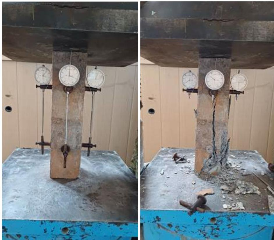
Рис. 4. Эталонный образец до и после испытания
