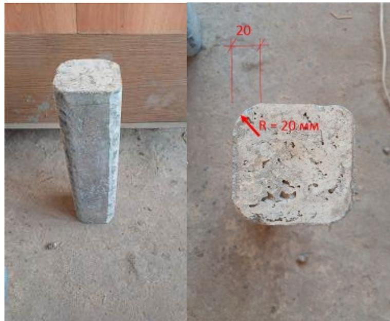
Рис. 1. Общий вид бетонного образца со скругленными углами
